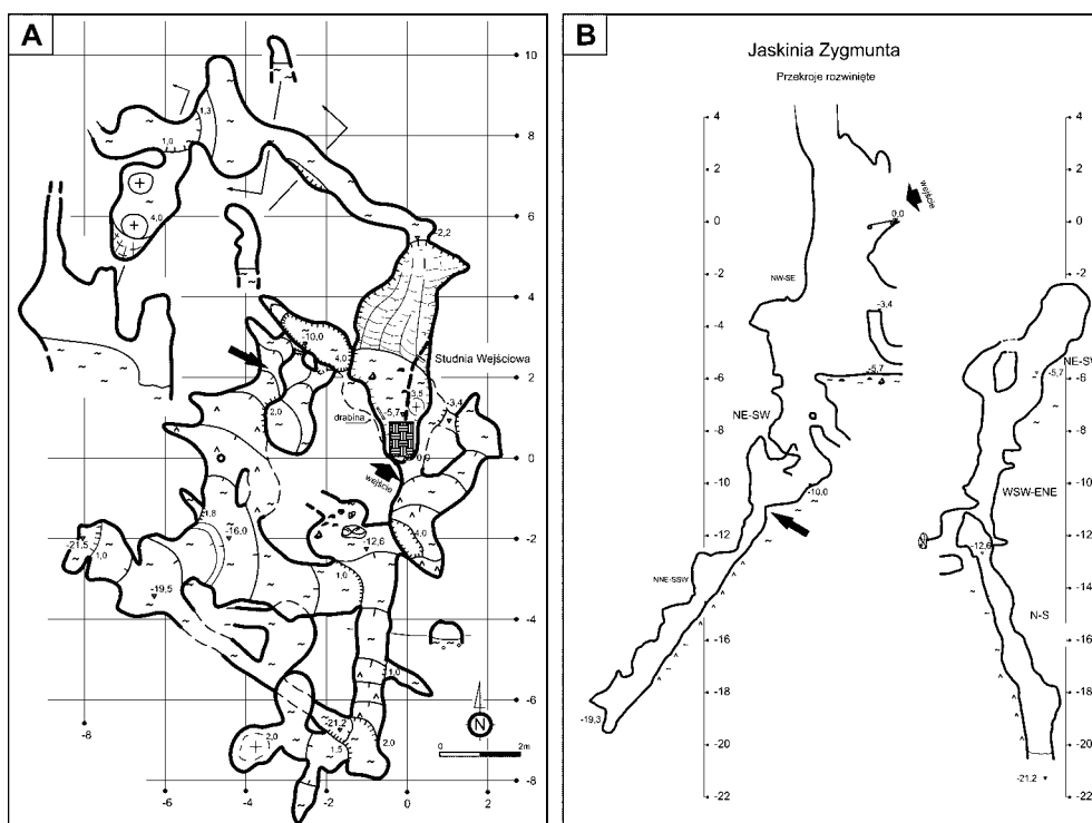
Ryc. 2. Plan jaskini Zygmunta (A) oraz przekroje rozwinięte (B) z zaznaczonym miejscem wykonania profilu (duże czarne strzałki).
