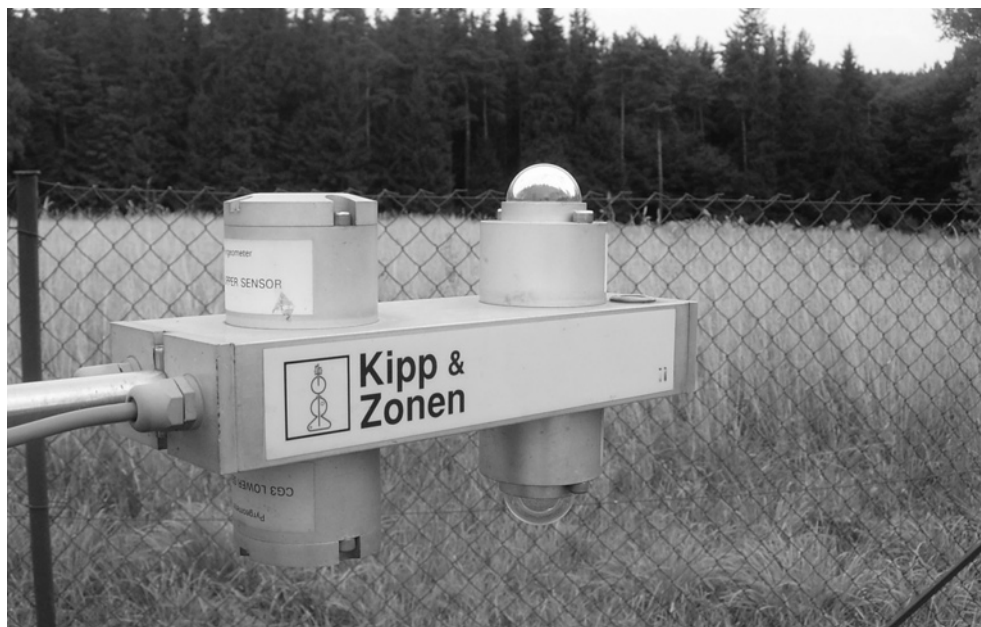
Ryc. 1. Radiometr różnicowy CNR1. Fot. Z. Caputa
