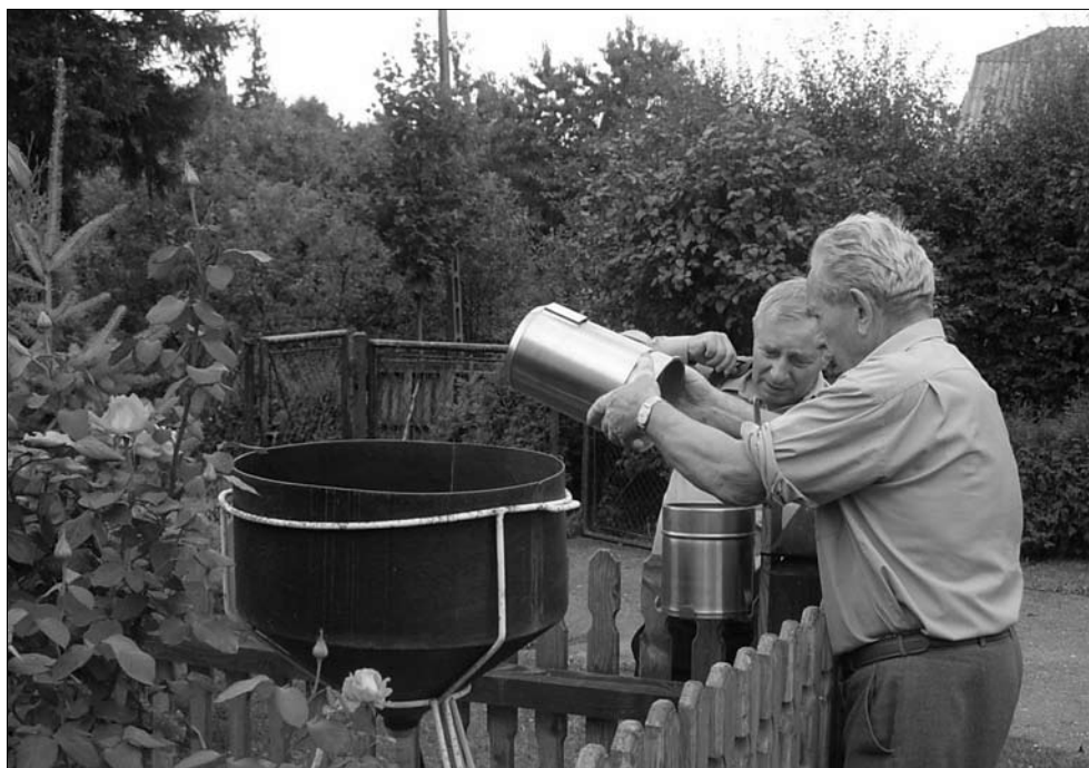
Ryc. 4. Kolektor opadowy i deszczomierz Hellmanna w Lepiance Czajowskiej. Na zdjęciu od lewej: prof. Tadeusz Niedźwiedz i Piotr Skalniak (obserwator). Fot. Z. Caputa
